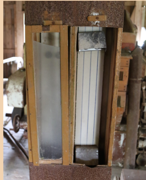
Pöyliön myllyn kerrosten välillä kulkeva remmivetoinen elevaattori.
