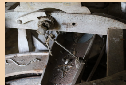
Soppanan myllyn porsaan kannatusvitsasten säätömekanismi. Porsaan pohjassa näkyy siivilä, jonka läpi epäpuhtaudet tippuneet lattialle.
