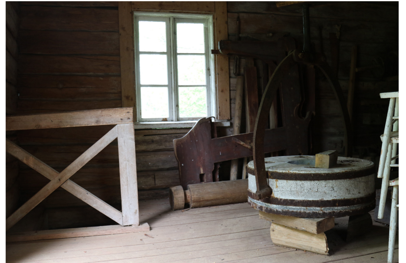
Etualalla Uulan myllyn kuorintakiviparin ylempi jauhinkivi saksinostimessa. Takana näkyy rikkoutuneen elevaattorin osia ja vasemmalla myllyn sisäportaan kaide.
