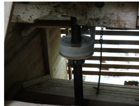
Vasemmalla edessä Uulan myllyn jauhinkiviä pyörittävä pienempi hammasratas, jota pyörittää takana näkyvä suurempi hammasratas. Yllä näkyy vesiturbiinin väkipyörä, joka pyörittää puolestaan suurta hammasratasta.
