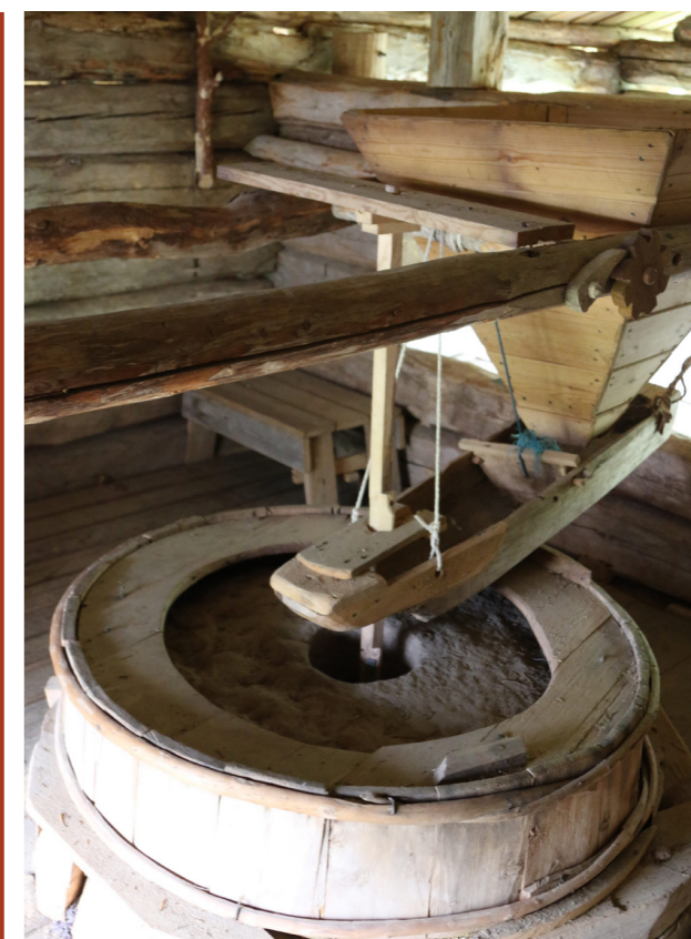
Kuittarin ratasmyllyn syöttö- ja jauhatuslaitteet.
