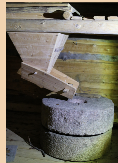
Kampsajoen härkinmyllyn tuutti, porsas ja molemmat jauhinkivet. Yhteyttä siipitukkiin ei enää ole.
