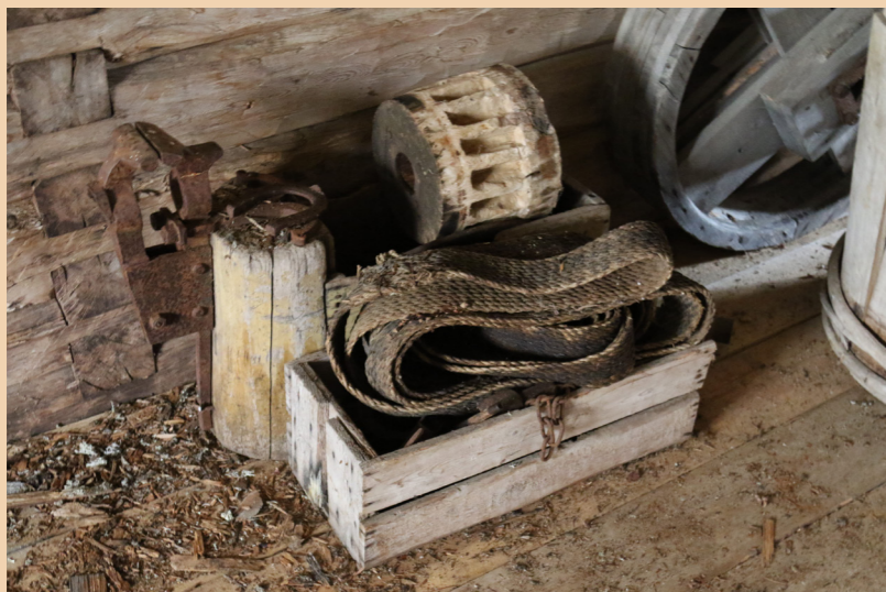
Soppanan myllyn alkuperäinen itse tehty manillaremmi myllyrakennuksen yläkerrassa. Kuvassa näkyy myös joen toisella puolella sijainneen yksinkertaista voimavälitystä hyödyntäneen pienemmän ratasmyllyn vanha lyhtypyörä sekä mm. hevosenkenkien väntämiseen käytetty ruuvipenkki.
