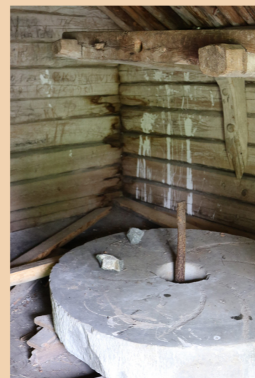
Tuomiojan härkinmyllyn syöttölaitteen teline kiinni seinässä ja alakivi lepää korotetulla jauhopöydällä.
