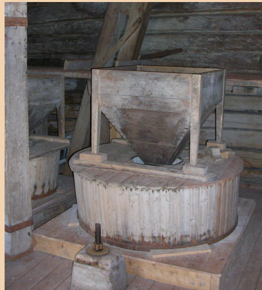
Uulan myllyn jauhatus- ja syöttölaitteet. Kahan edessä näkyy ylempään jauhinkiven säätöruuvi.
