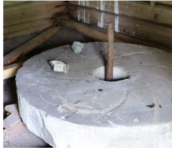
Tuomiojan myllyn siipitukin väkirauta, jossa kiinni ollut siilirauta on pyörittänyt ylemmää jauhinkiveä.
