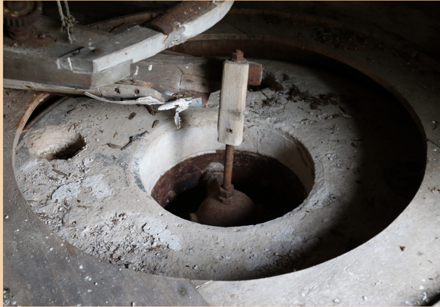
Soppanan myllyn kivien tiedetään olevan läpimitaltaan 1200 mm ja painavan 600 kg per kivi. Muista alueella säilyneistä ratasmyllyistä tällaista tietoa ei ole, mutta Soppanassa muisteltiin joen toisella puolella sijainneen vanhan pienemmän ratasmyllyn kivien olleen läpimitaltaan 800 mm ja kauempana Vohjoella sijainneen myllyn 600 mm. (Niemelä, 31.7.2025)
