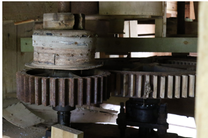
Vasemmalla edessä Uulan myllyn jauhinkiviä pyörittävä pienempi hammasratas, jota pyörittää takana näkyvä suurempi hammasratas. Yllä näkyy vesiturbiinin väkipyörä, joka pyörittää puolestaan suurta hammasratasta.
