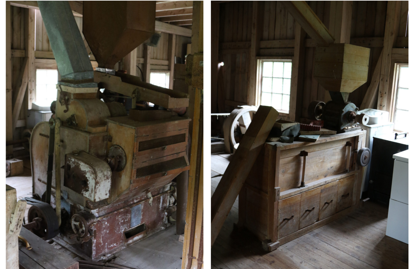
Pöyliön myllyn lisälaitteita myllyn keskimmaisessä kerroksessa: vasemmalla luultavasti kuorimakone ja oikealla vuonna 2021 ilkivallan seurauksena rikkoutunut ryynikone. Kolmannessa kerroksessa tiedetään lisäksi olleen kaurahiutalekone, joka litisti kauraryynit hiutaleiksi.
