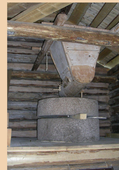
Ulkujoen härkinmyllyn tuutti, porsas ja molemmat jauhinkivet. Kuvassa näkyy myös karistinkeppi sekä kannatusvitsaksia. Kuva: Henri Turunen, 2007.
