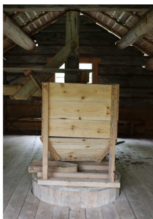
Soppanan ratasmyllyn syöttö- ja jauhatuslaitteet.
