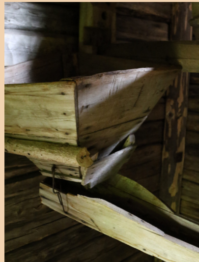
Erkkilän tuulimyllyn tuutti ja tuutin aukon säätöluukku sekä porsas ja porsaan kannatusvitsakset.
