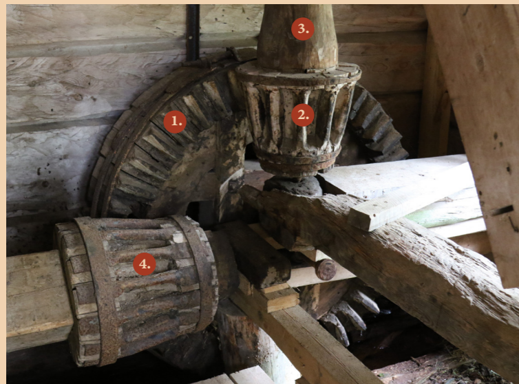
Naumaniemen myllyssä alakerroksessa sijaitseva vesirattaan vaaka-akseli pyörittää suurta puisesta hammasratasta (1.), joka siirtää voiman lyhtypyörälle (2.). Lyhtypyörä (2.) pyörittää puolestaan pystyakselin (3.) avulla yläkerroksessa siiliraudan varassa lepäävää ylempää jauhinkiveä. Vaaka-asennossa oleva lyhtypyörä (4.) välittää voimaa puolestaan sahan remmipyörälle.
