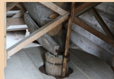
Edessä Naumaniemen myllyn karistinkeppi ja takana tuutin aukon säätöluukku.
