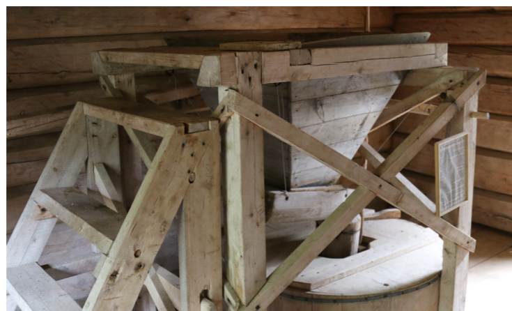
Soppanan ratasmyllyn syöttö- ja jauhatuslaitteet.
