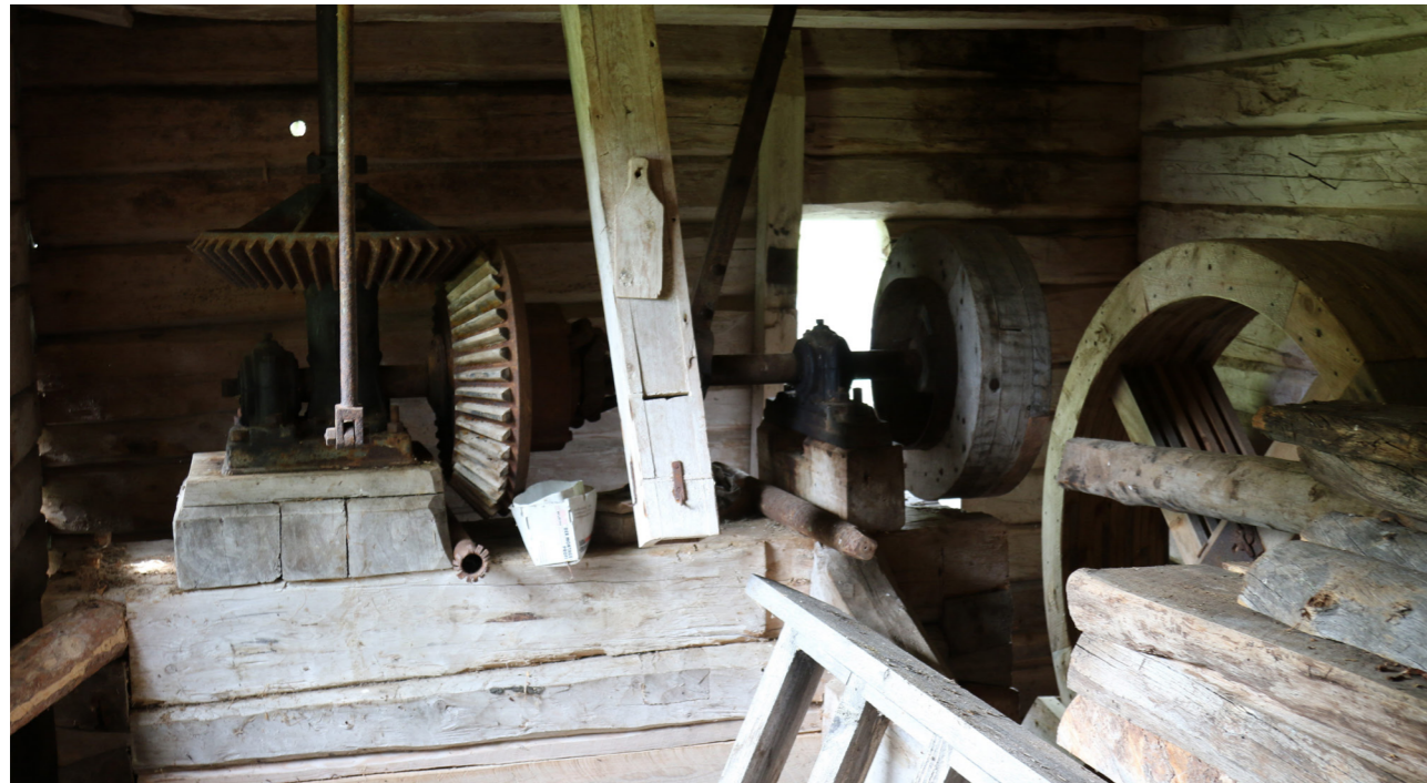
Soppanan myllyn välityslaitteiston remmipyöriä, väkirautoja ja hammasrattaita. Soppanan myllyn välitysmekanismeista lisää työn neljännessä osassa.
